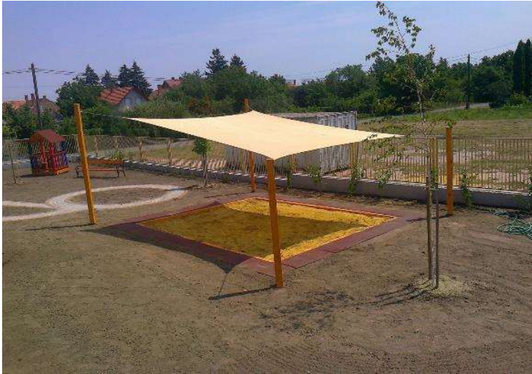
Árnyékoló szerkezet 10 m 2 (játszóudvar) - Napvitorla 3,6 m x 3,6 m, horganyzott fém lábakon
